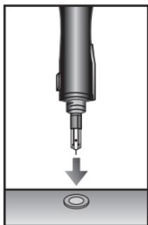
Drücken Sie die Lanzette in die Lanzettenkappe.
