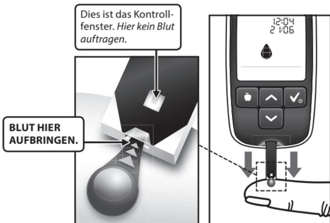
Der BGStar® Teststreifen funktioniert wie ein Schwamm und zieht das Blut durch den Probenbereich in den Streifen. Das Kontrollfenster des Teststreifens färbt sich rot.
