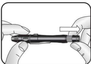
6. Spannen Sie die Stechhilfe, indem Sie die Kappe festhalten und die Spannvorrichtung mit der anderen Hand herausziehen, bis sie einrastet.
