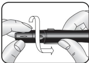
4. Setzen Sie die Kappe wieder auf die Stechhilfe auf und drehen Sie sie im Uhrzeigersinn bis zur Ausgangsposition zurück.
