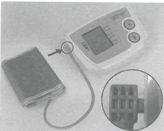
Pressen Sie den Anschlussstecker deshalb nicht bündig bis zum Anschlag, sondern nur bis zum Einrasten ein. In der korrekten Position hat der Stecker einen Abstand von 3 - 4 mm zum Gehäuse. ( siehe Abbildung )
